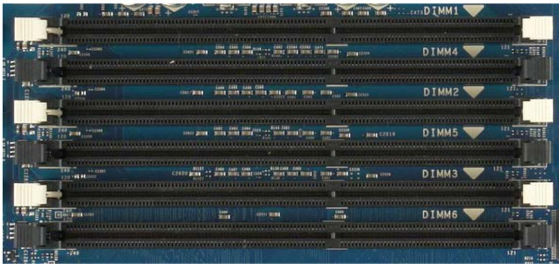
Zusätzlich verfügt der Dualprozessor-Riser über sechs weitere Speichersteckplätze. Die Steckplätze sind von DIMM1 bis DIMM6 nummeriert. DIMM1 ist am weitesten vom Prozessor entfernt.
