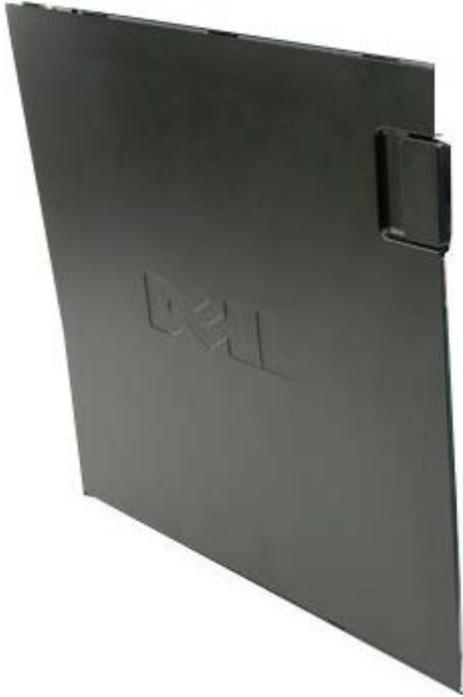
2. Schieben Sie die Freigabevorrichtung der Abdeckung zur Rückseite des Computers.
