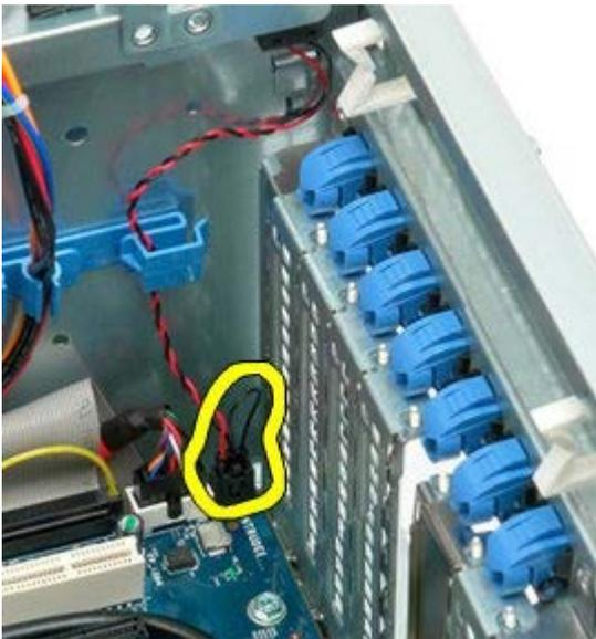
4. Entfernen Sie das Kabel des Gehäuseeingriffschalters von der Systemplatine.
