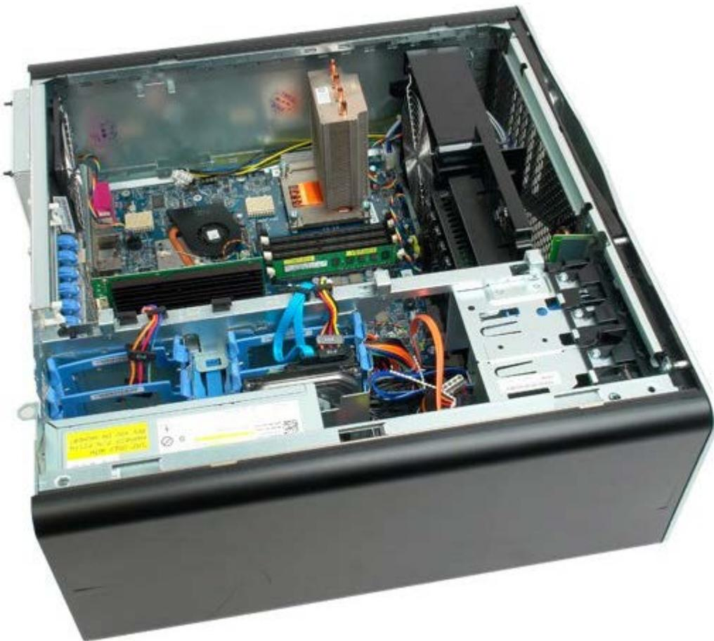
4. Drücken Sie die Sicherungsklammern an beiden Enden des Speichermodulanschlusses nach außen.
