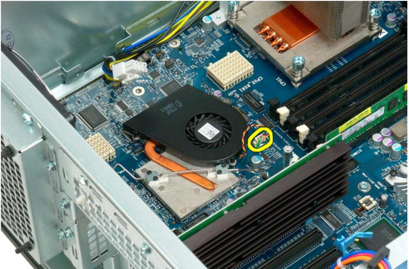
5. Entriegeln Sie die Metallklammer an einem Ende der Systemplatine.
