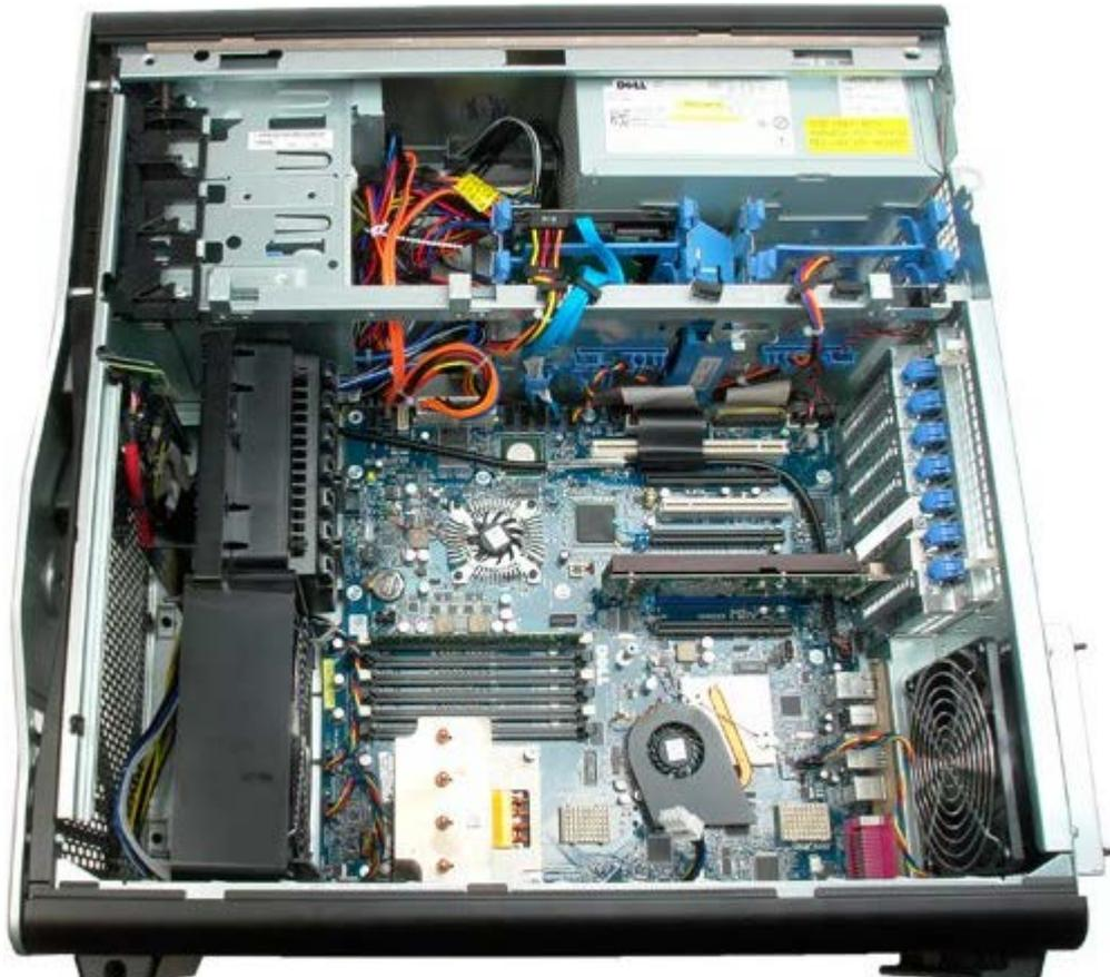
4. Trennen Sie die beiden Lüfterkabel von der Systemplatine.
