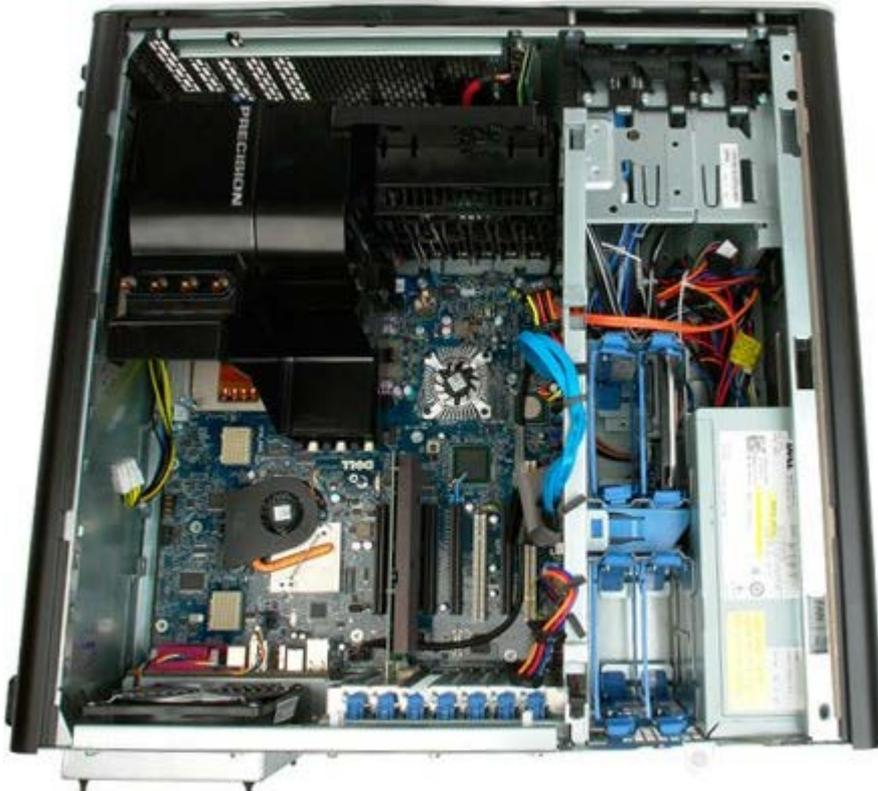
3. Entfernen Sie alle installierten Festplatten und deren Führungsvorrichtungen.
