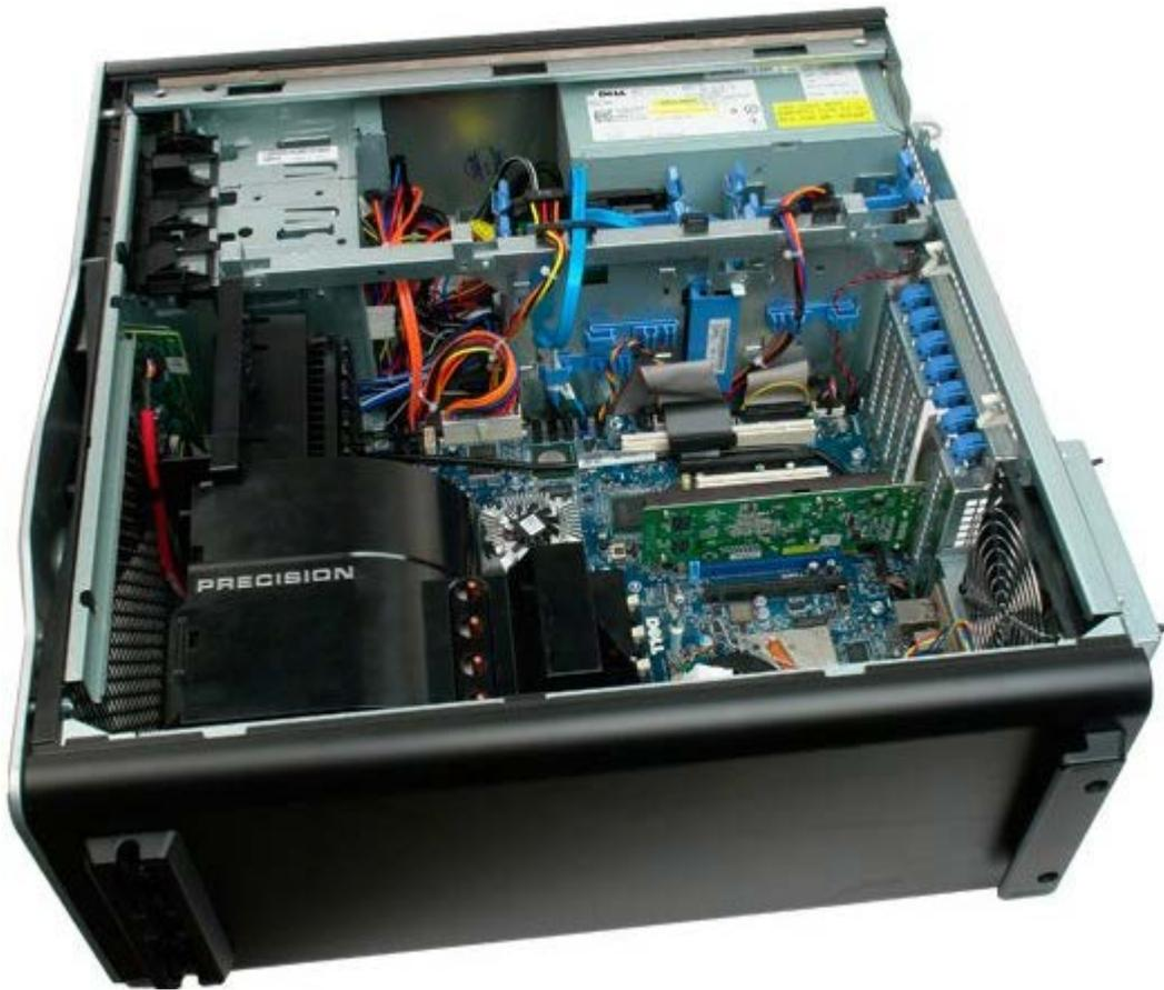
3. Trennen Sie das Kabel des Gehäuseeingriffschalters von der Systemplatine.
