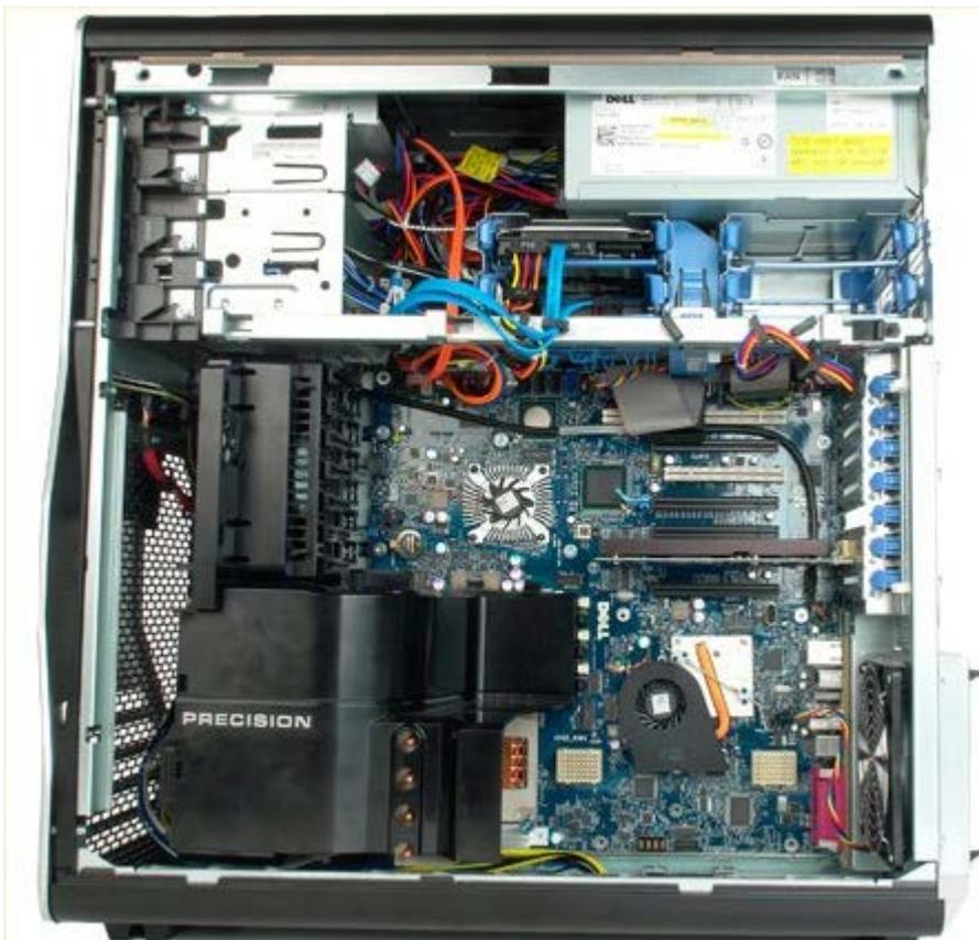
3. Trennen Sie das Kabel des Festplattenlüfters von der Systemplatine.
