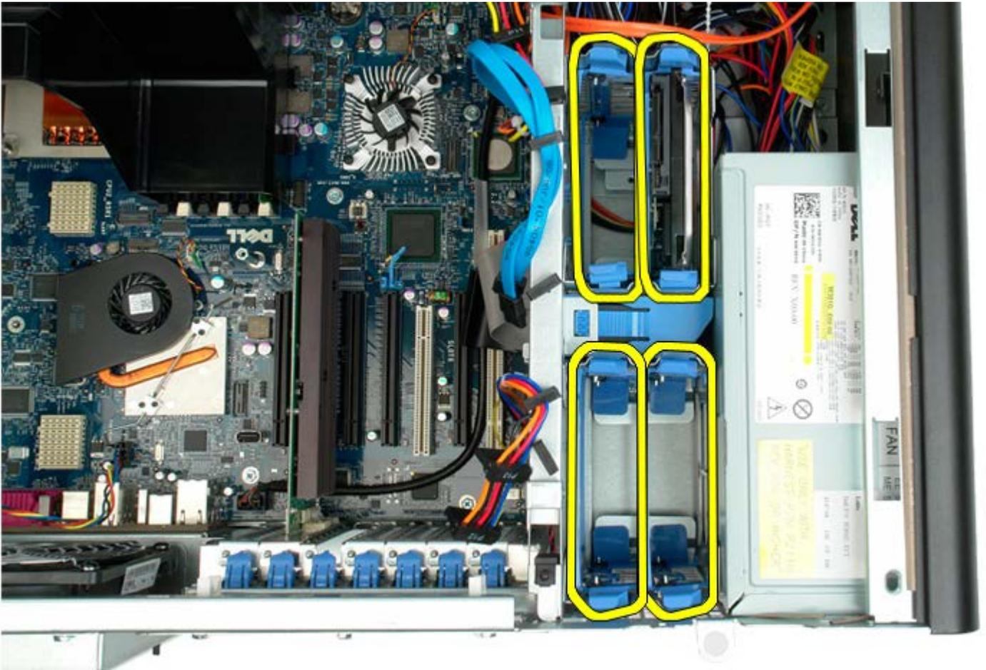
4. Entfernen Sie die Schrauben, die das erste Festplattengehäuse mit dem Systemgehäuse verbinden.
