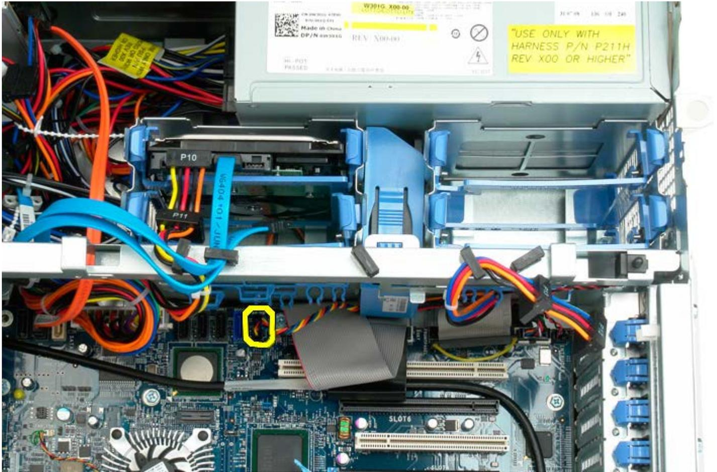
4. Trennen Sie das SATA-Kabel, um den Festplattenlüfter herausziehen zu können.
