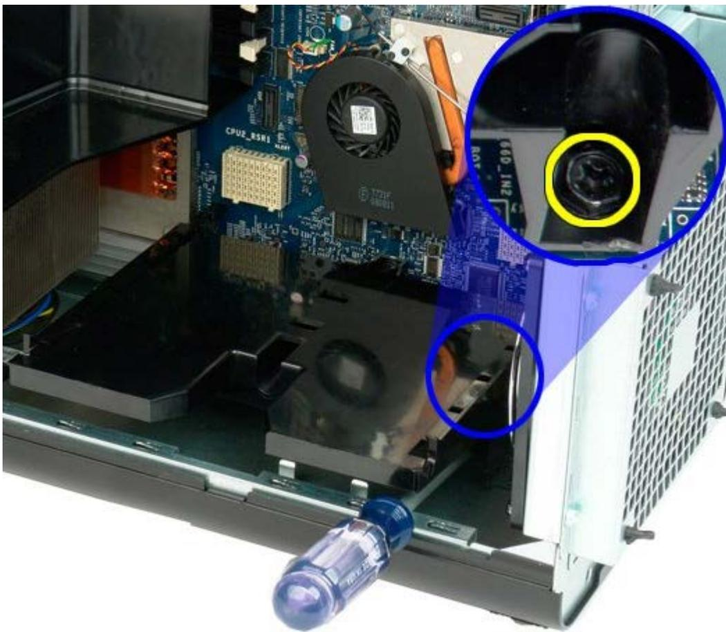
5. Entfernen Sie die letzte Schraube, die die Führungsvorrichtung des Risers am Computer sichert.
