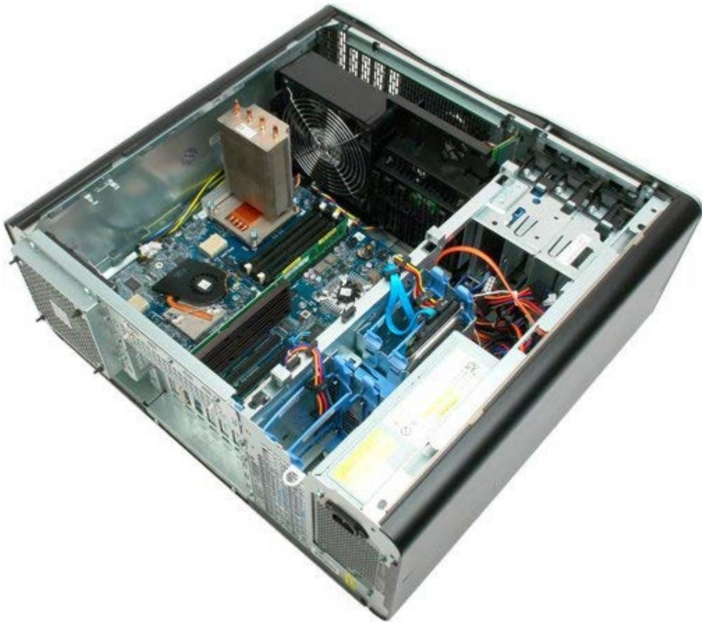
4. Trennen Sie das Kabel des Prozessorlüfters von der Systemplatine.
