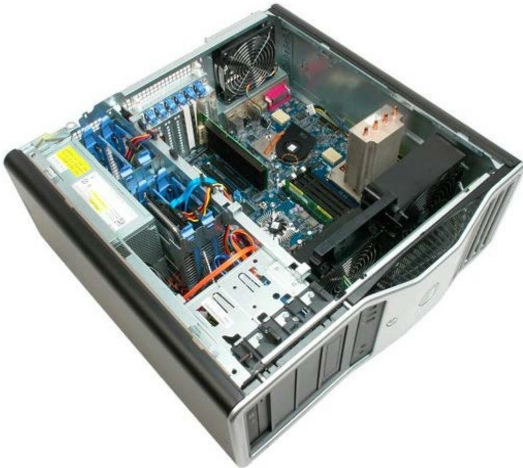
3. Trennen Sie das Kabel des hinteren Speicherlüfters von der Systemplatine.
