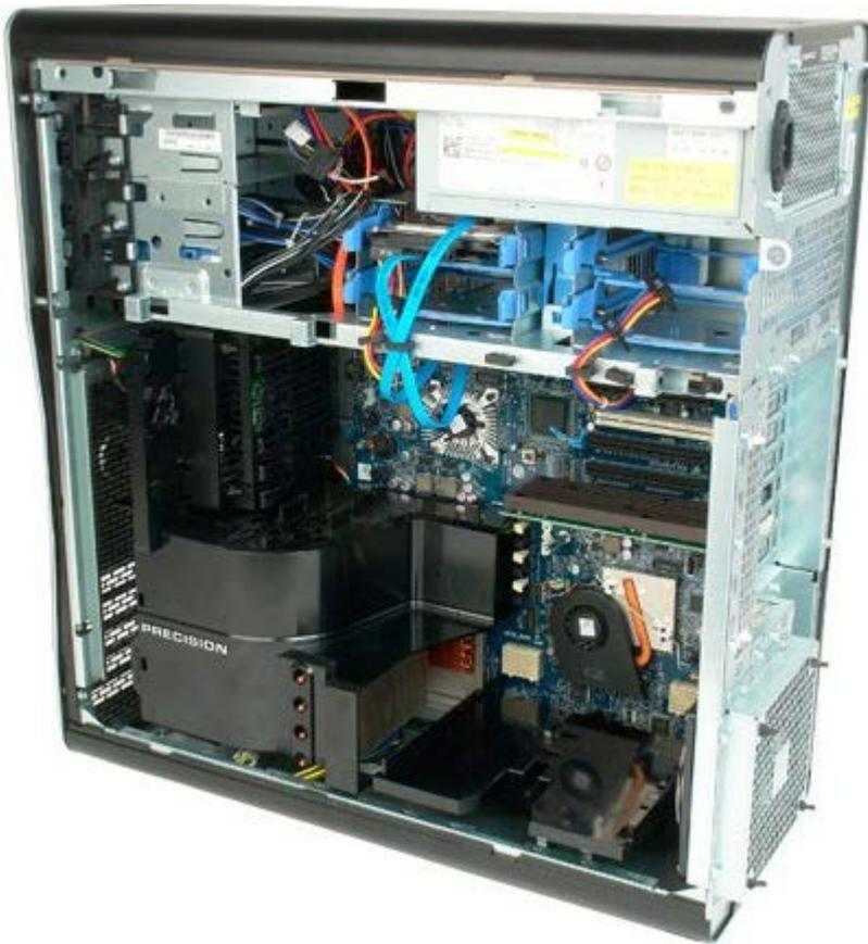
3. Verwenden Sie einen langen Kreuzschlitzschraubendreher, um die erste Schraube zu entfernen, die sich zur Mitte des Computers hin befindet.
