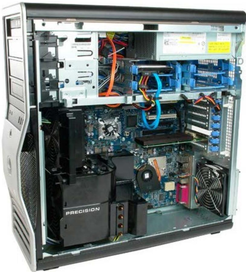
3. Drücken Sie den Hebel der Schnellverschluss-Platte in Richtung Computersockel und entriegeln Sie die Laufwerksblende.
