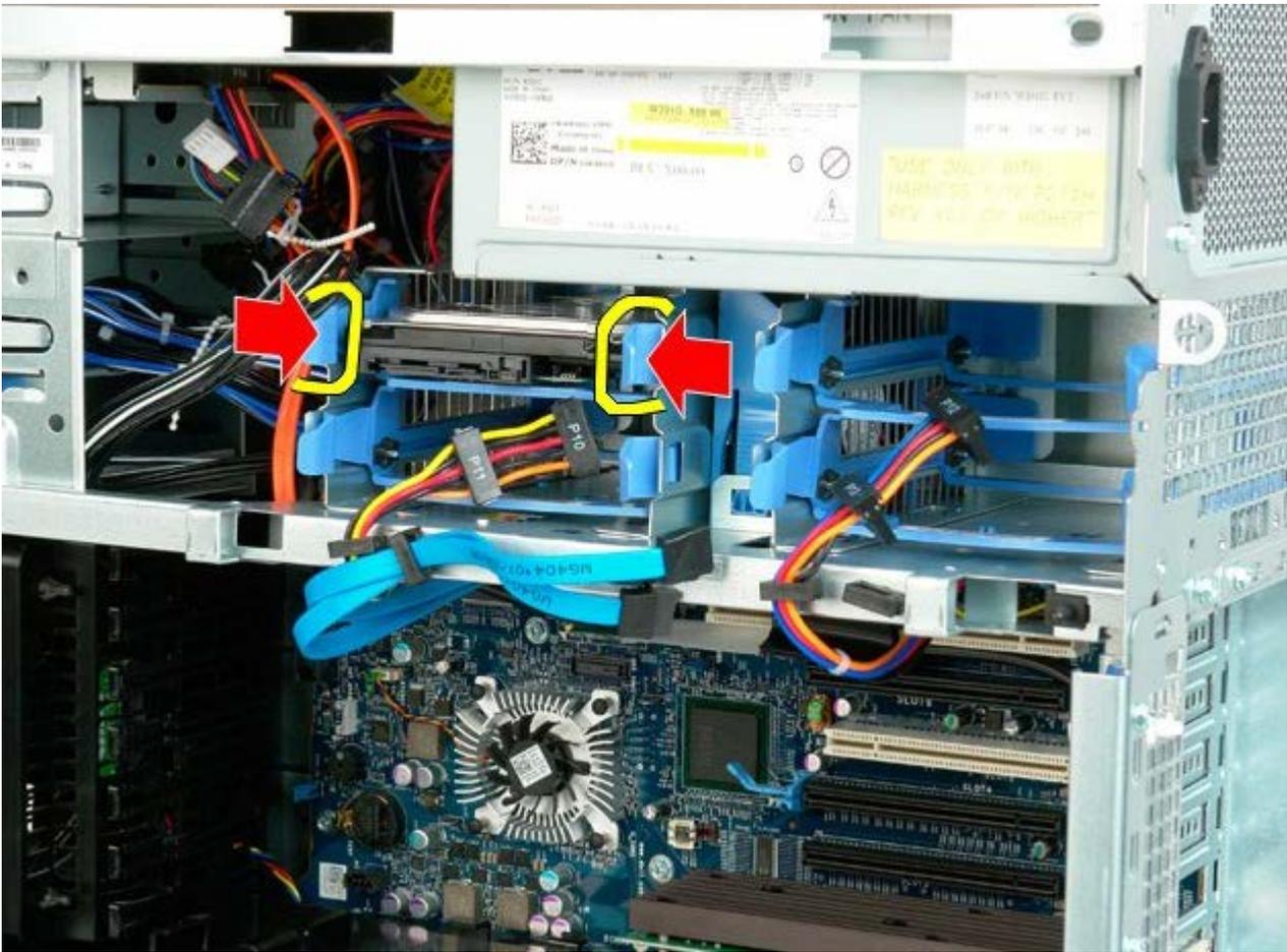
5. Entfernen Sie die erste Festplatteneinheit aus dem Festplattengehäuse.
