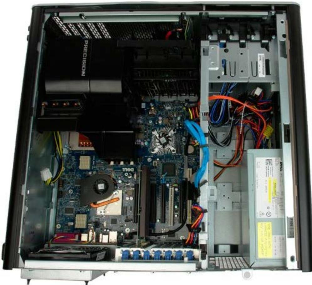
4. Trennen Sie das Kabel des Netzteils auf der Rückseite des Netzteils.
