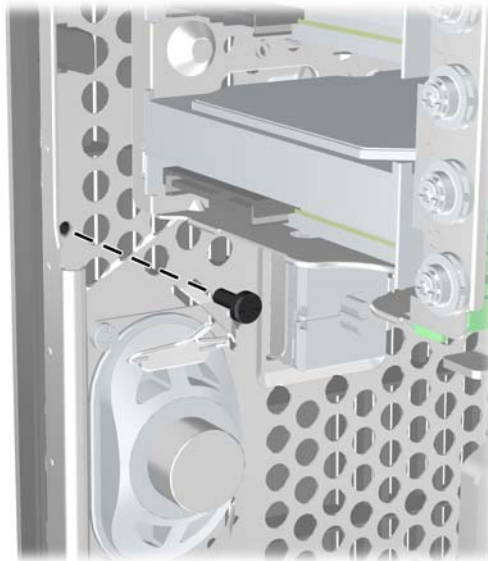
Abbildung C-8 Installieren der Sicherheitsschraube für die Frontblende
