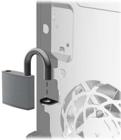
Abbildung C-2 Anbringen eines Vorhängeschlosses
