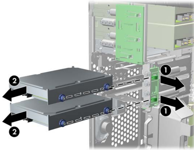
Abbildung 2-29 Entfernen einer Festplatte
