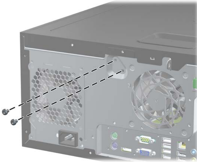
Abbildung 2-1 Entfernen der Schrauben des Smart Cover Lock
