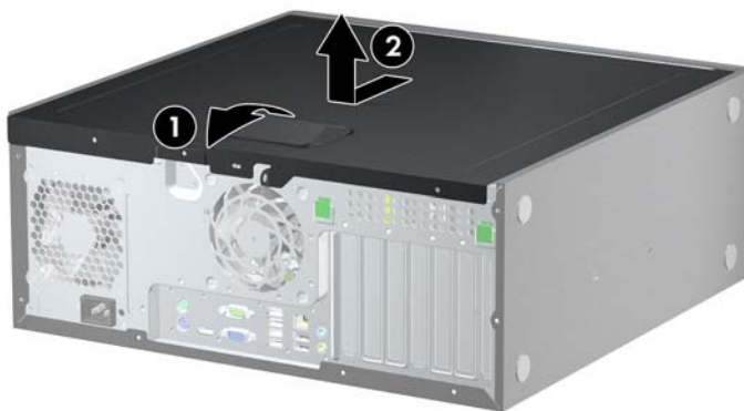
Abbildung 2-2 Entfernen der Abdeckung
