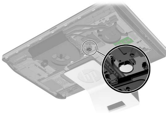
Abbildung 2-24 Positionierung der Batterie
