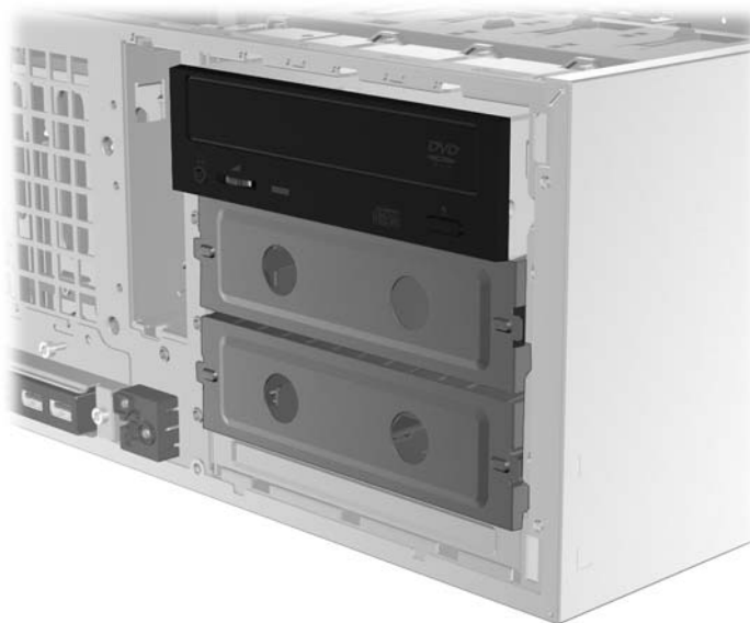
Abbildung 3-7 Erneutes Installieren des optischen Laufwerks
