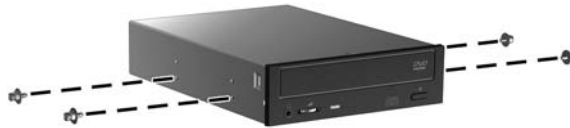
Abbildung 10-1 Einsetzen der Führungsschrauben
