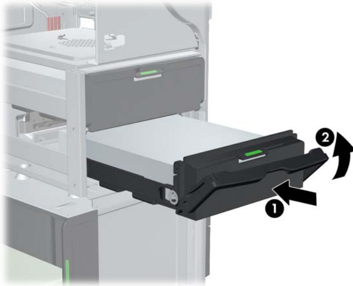
Abbildung 9-6 Installieren der HDD im Gehäuse
