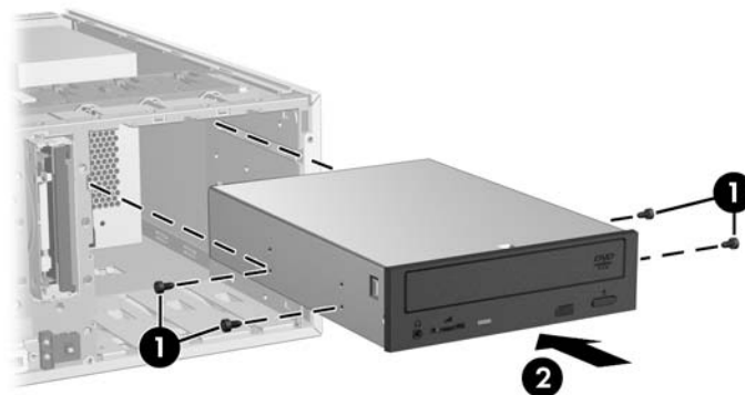
Abbildung 10-3 Installieren des optischen Laufwerks
