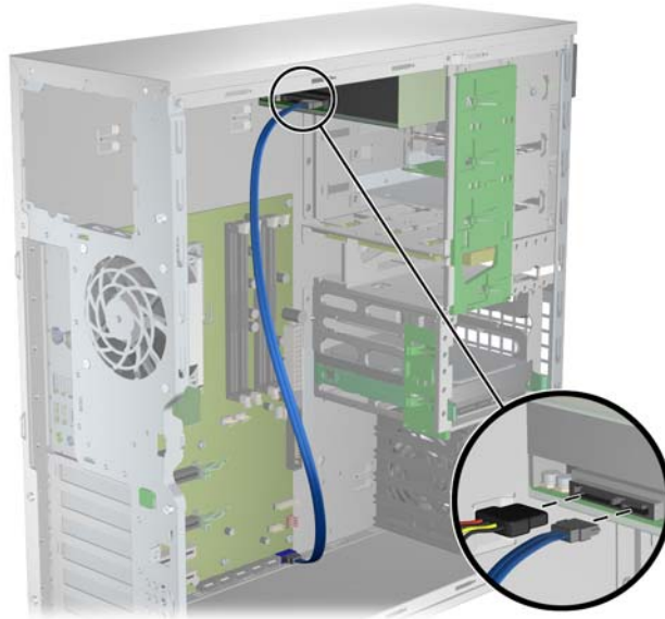
Abbildung 10-2 Verbinden von ODD-Netz- und -Datenkabeln
