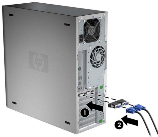
Abbildung 3-8 Anschließen der Kabel an der Workstation
