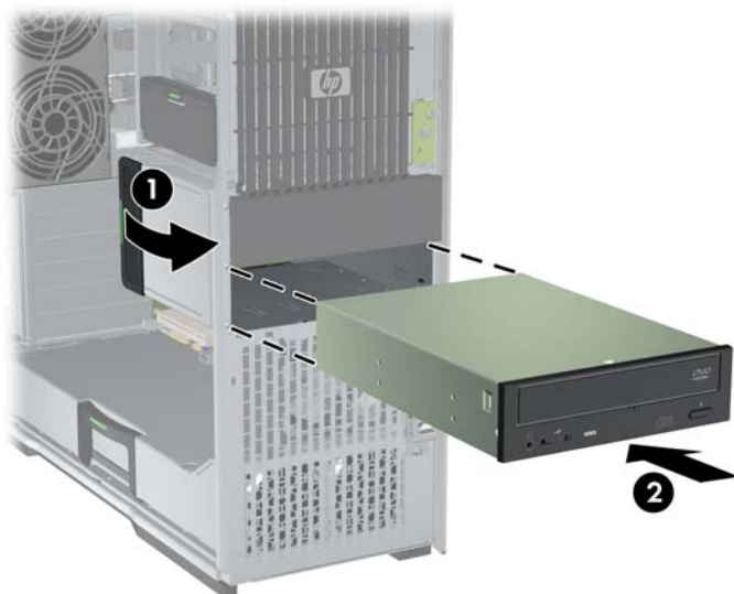
Abbildung 10-4 Installieren des optischen Laufwerks
