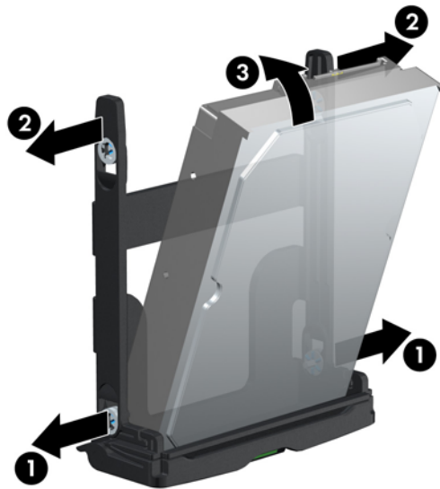
Abbildung 9-5 Installieren des Laufwerks im Träger
