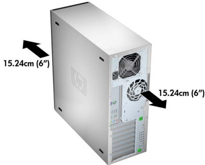
Abbildung 3-1 Geeignete Belüftung der Workstation
