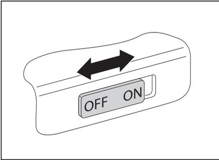
► Schieben Sie den Ein-/Ausschalter in die Position "ON", um die Funkkomponenten einzuschalten.
