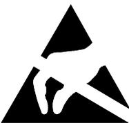
Baugruppen mit elektrostatisch gefährdeten Bauelementen (EGB) können durch den abgebildeten Aufkleber gekennzeichnet sein.
