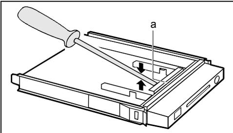
Bei der Auslieferung ist der Schlitz für die SmartCard auf der Innenseite des Einschubs durch einen Plastikriegel geschützt.
