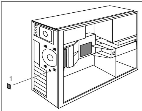
Der Lüfter ist richtig eingerastet, wenn die Rastnase (1) an der Gehäuserückwand leicht heraussteht.
