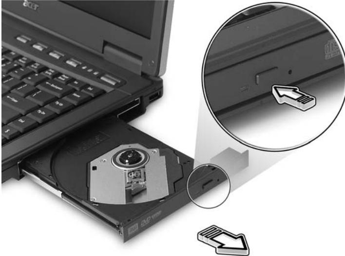
Stecken Sie eine Büroklammer in das Auswurfloch, um den Träger des optischen Laufwerks herauszufahren, wenn der Computer nicht eingeschaltet ist.
