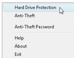
Wenn Sie diese Funktion auswählen, werden die Datenübertragungen zur Festplatte angehalten, falls von der Festplatte Vibrationen oder Bewegungen registriert werden, die die maximal zulässige Stärke überschreiten.
