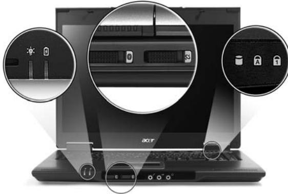
Die Statusanzeigen für Strom, Akku, Bluetooth und Wireless-Kommunikation sind selbst dann zu sehen, wenn die LCD-Anzeige geschlossen ist.
