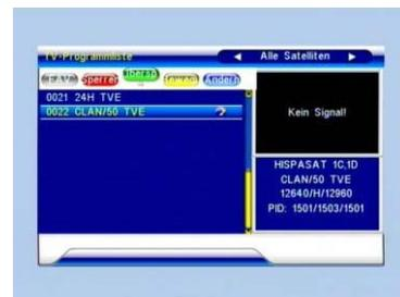
6. Drücken Sie die **gelbe** Taste, um die Verschieben-Taste nach oben zu verschieben. Wählen Sie den gewünschten Sender, und drücken Sie **OK**, um den aktuellen Sender zu markieren. Drücken Sie die Tasten **PR+**, **PR-**, um den Cursor auf die Position zu bewegen, an die Sie den Sender verschieben möchten, und drücken Sie **OK** zur Bestätigung.
