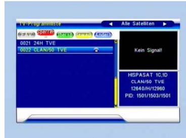
5. Drücken Sie die **grüne** Taste, um die Überspringen-Taste nach oben zu verschieben. Wählen Sie den gewünschten Sender, und drücken Sie **OK**, um den aktuellen Sender mit einem Überspringen-Symbol zu markieren. Sie können die Markierung aufheben, indem Sie noch einmal **OK** drücken.
